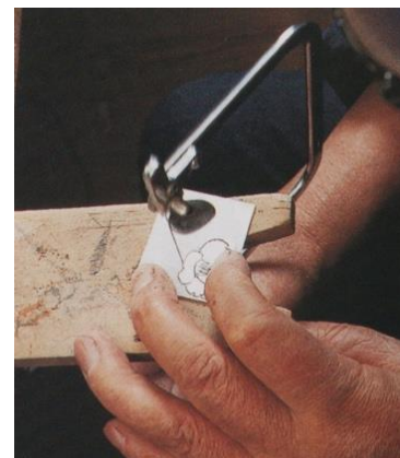
図 16 厚貝を糸鋸で切り抜く
