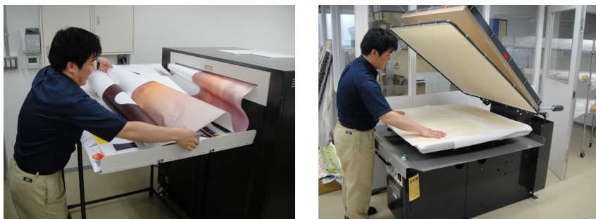
図46 長瀬産業の転写 転写紙にプリント-高温プレス
