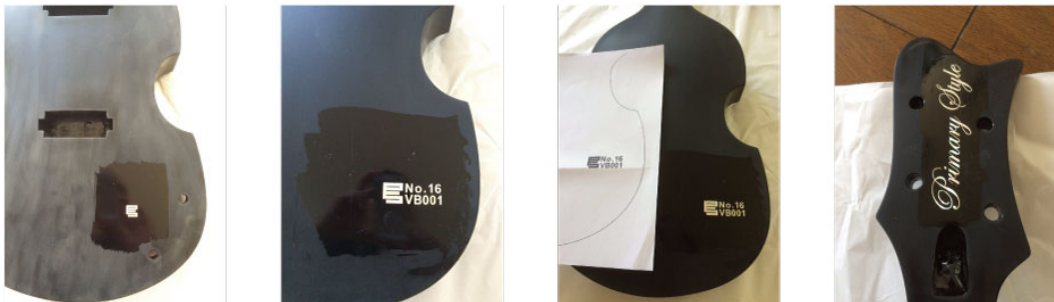
図 ※43 中塗りと螺鈿位置検証（高岡・工房）
