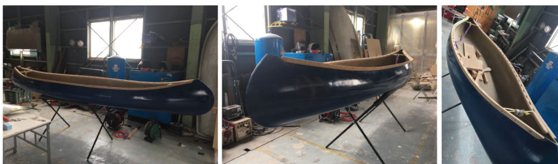
図 ※63 下地塗装 (高岡・工房)
