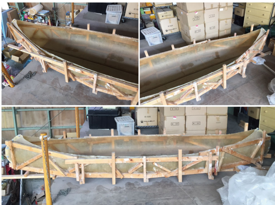
図 ※62 FRP 型の調整 (高岡・工房)
