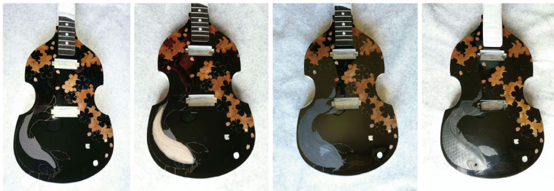
図 ※47 左 2 枚錆び上げ 右 2 枚炭粉子上げ (金沢・工房)
