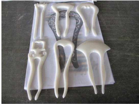
図 ※28 ポリアセタールから削り出した簪
