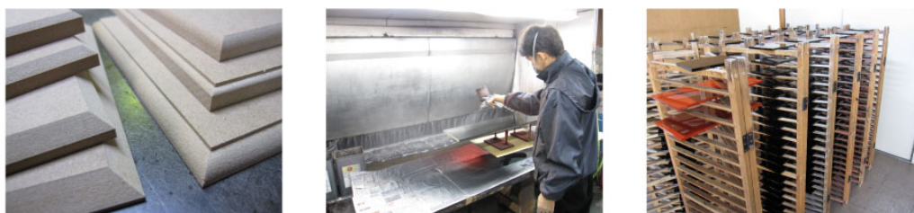
図 ※32 制作工程 (左・生地 中・ウレタン漆吹付 右・乾燥)
