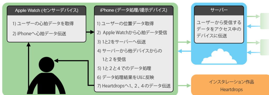
図8. 《PulseCloud》のシステム構造図
