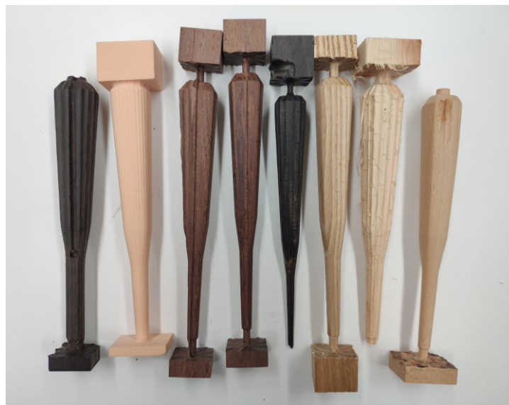
図40 CNC加工の失敗例
