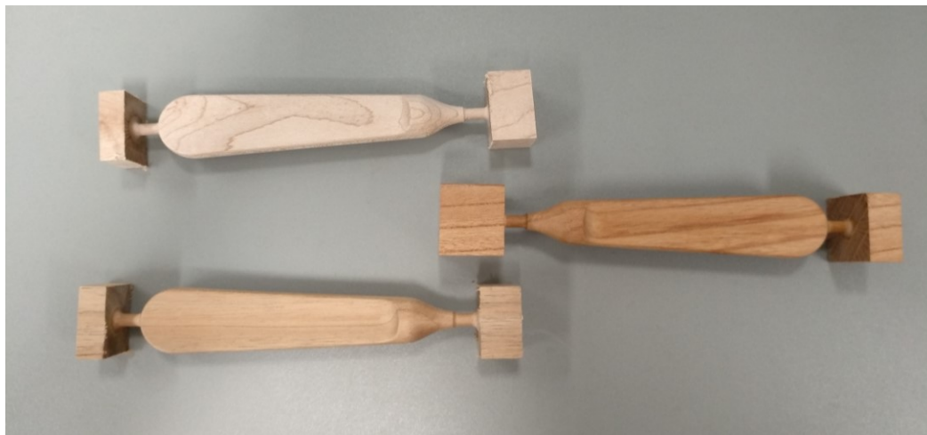
図 82 CNCで削り出した新しい糸巻
