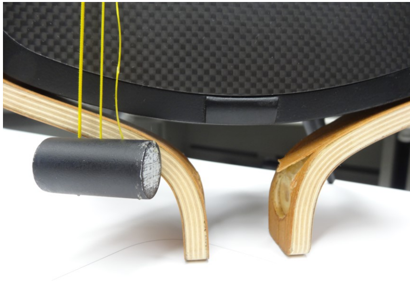
図 44 破損した前作のプロトタイプ
