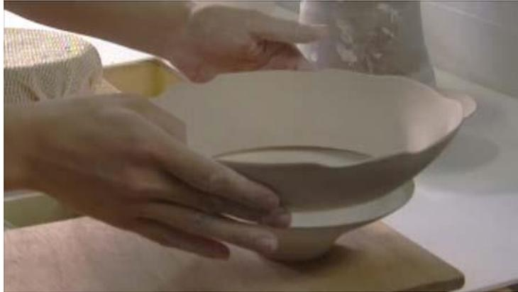
図 30 底部のパーツに切り出したパーツを重ねる
