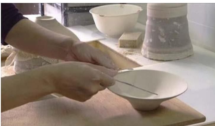
図 28 底部の器形の上にオーバーラップさせて重ねるパーツの切り出すサイズを計る
