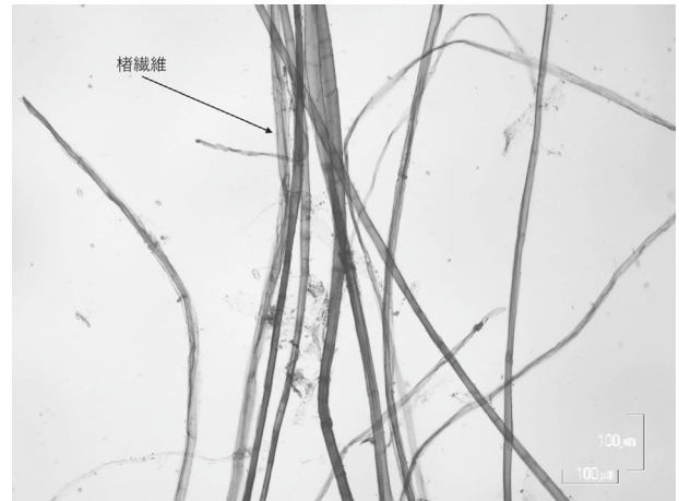
図6 「奉書」顕微鏡写真（100倍）
